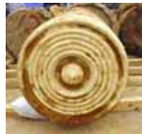
きっちり工事した場合の 実際の改良体底面の写真
